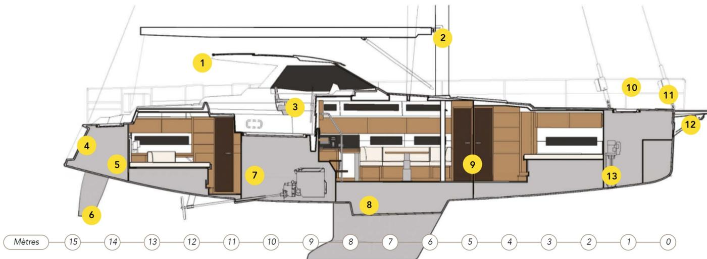
1. Cockpit central avec abri rigide, toit ouvrant et panneaux photovoltaïques
