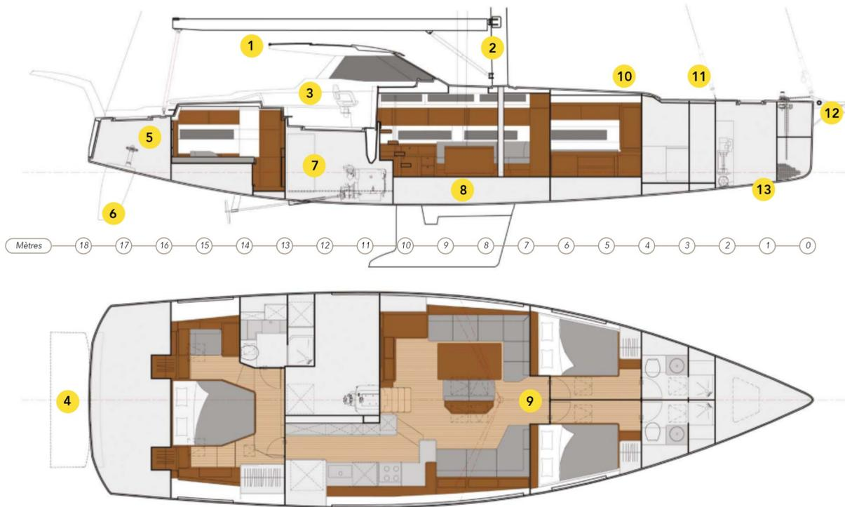
1. Cockpit central avec abri rigide, toit ouvrant et panneaux photovoltaïques
